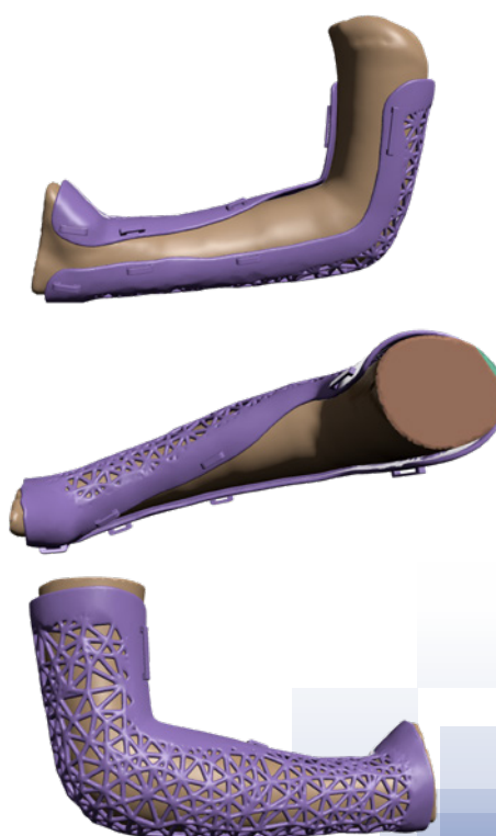
Obr. 4: 3D model personalizovanej ortézy
